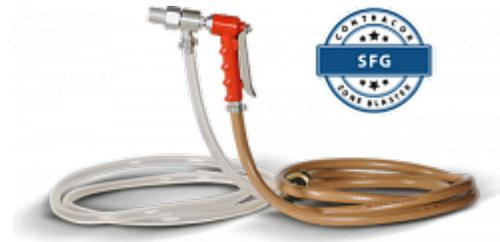
Абразивоструйный пистолет SFG Gun работает по принципу эжекторного распылителя. В камере за воздушной форсункой создается разрежение, в результате чего происходит забор абразива по рукаву. Абразив подает в камеру через соответствующий штуцер, смешивается с основным воздушным потоком и выносится через сопло. При направлении воздушноабразивного факела в сторону очищаемой поверхности, происходит очистка.
